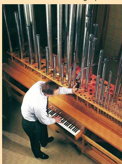
Um möglichst reine Pfeifenklänge zu erzeugen, lernte Jerome, dass das Mikrofon sehr nahe an jeder Pfeife platziert werden musste, um die Raumakustik auszuklammern (links). Zudem konnte so das Signal-Rausch-Verhältnis der Aufnahmen verbessert werden. Erst diese „Dry Sampling“-Technik („trockene“ Samples), die Allen auch heute noch anwendet, ermöglichte es, die digitalen Klän-
